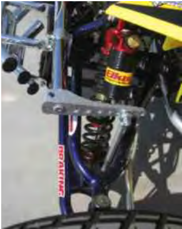
I bracci anteriori si possono dotare completamente di snodi uniball, così come i tiranti delle barre; il maggior costo iniziale si compenserà con affidabilità e precisione di guida.
